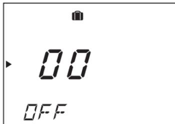
• Нажмите на кнопку (mode) четыре раза: При установке режима „Отпуск“ замигает символ 00 примерно на 10 секунд.
