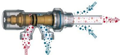
La valvola M 88 in posizione di massima apertura non ha il bypass e il 100% della portata dell'anello entra nel corpo scaldante (vedi immagine).
