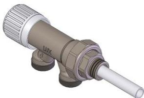
La valvola M 87 ha il bypass fisso, in posizione di massima apertura il 50% della portata dell'anello entra nel corpo scaldante.
