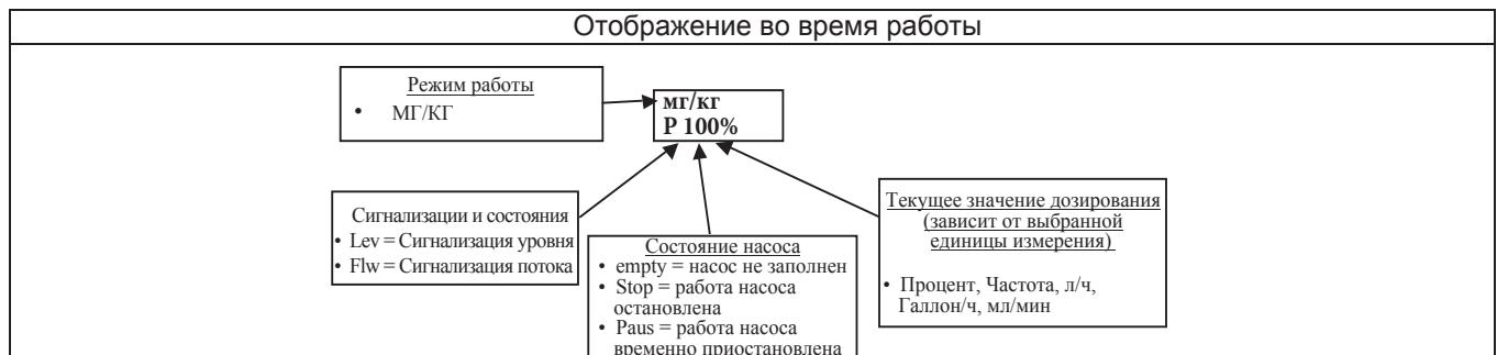
Параграф 8 - Дозирование по времени (*Входящий частотный сигнал "ТРИГГЕР" активирован*)
