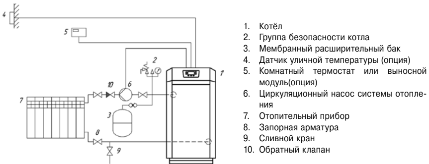
Рис. 6. Гидравлическая схема подключения котла к системе отопления
