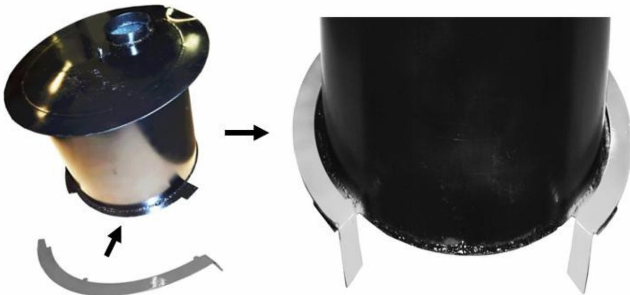
Изогнутые металлические пластинки (2 шт.) предназначены для прочистки котлов с внутренней стороны в случае накопления сажи. После установки котла их надо наложить через верхнюю дверцу на внутренний бачок, у которого есть вырез под них.
