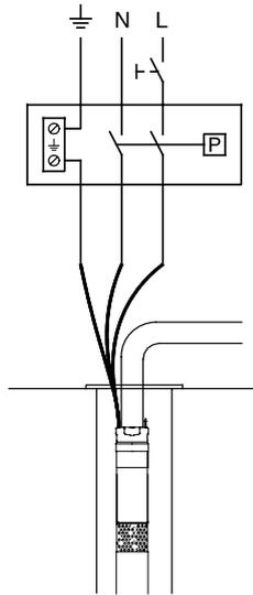
Рис. 29. Электросхема подключения насоса к сети
