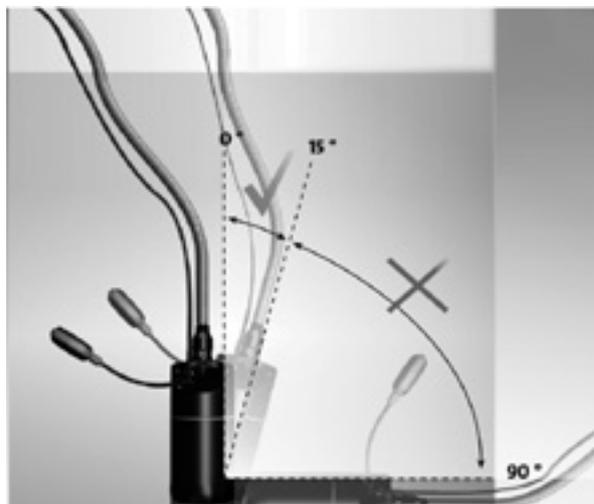
Рис. 51. Разрешенное рабочее положение установки / насоса
