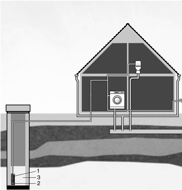
Рис. 48. Пример монтажа автоматических насосных установок SBA в колодце
