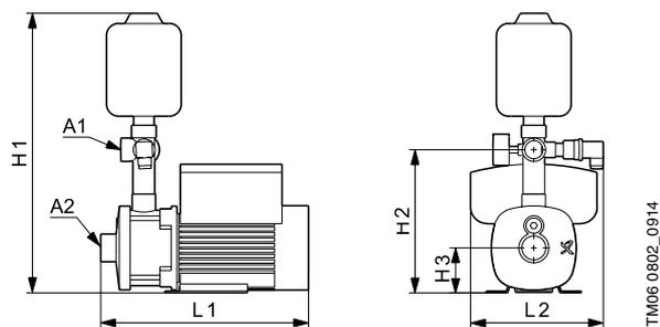
Рис. 39. Габаритные и присоединительные размеры насосов CME
