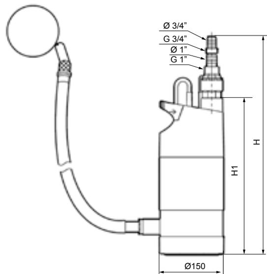
Рис. 55. Модель SB с поплавковым сетчатым фильтром
