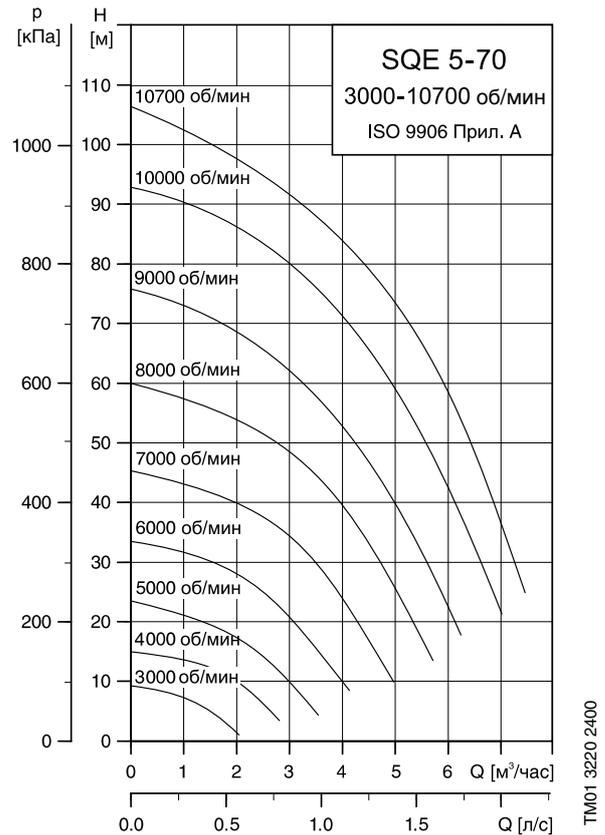
Рис. 25. Пример регулирования частоты вращения насоса SQE
