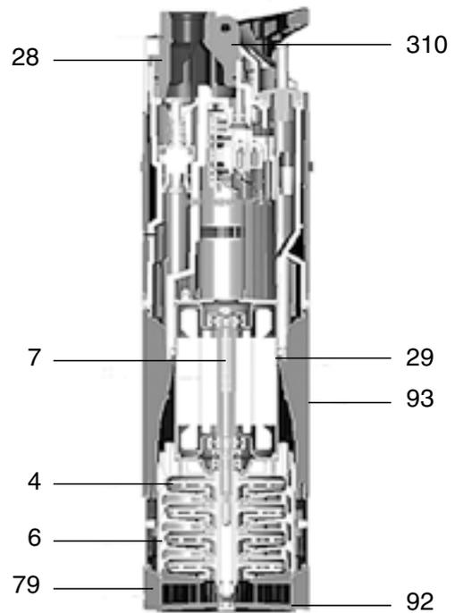
Рис. 50. Разрез установки SBA
