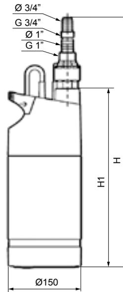
Рис. 53. Модель SB со встроенным сетчатым фильтром
