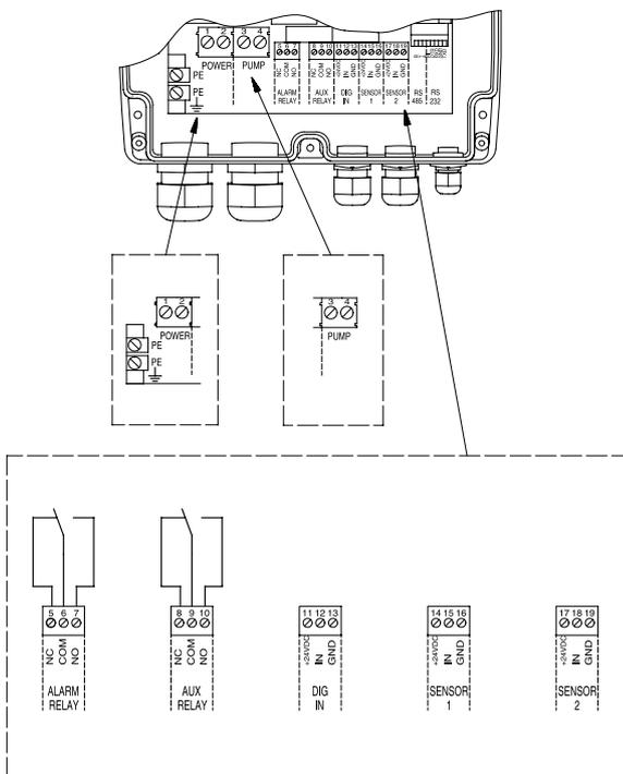
Рис. 30. CU 300 подключение
